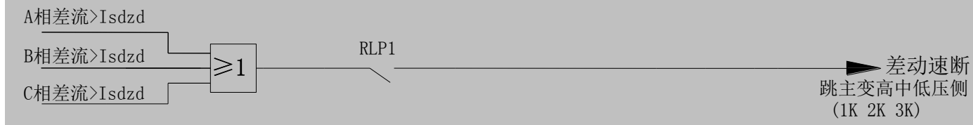
图 1 差动速断动作逻辑图
