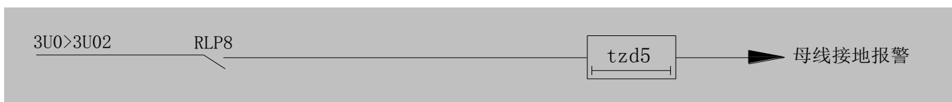
图 3 接地保护逻辑框图
