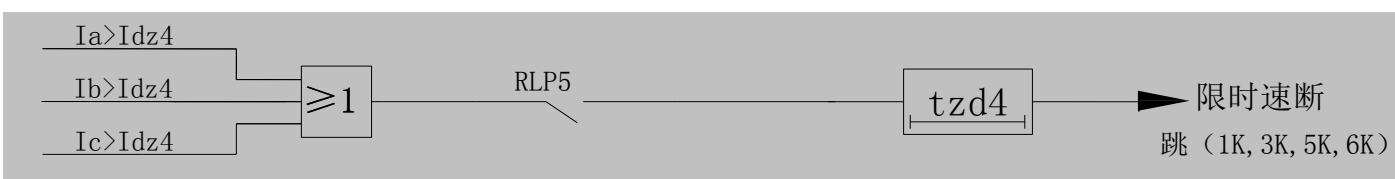
图 6 限时速断逻辑框图
