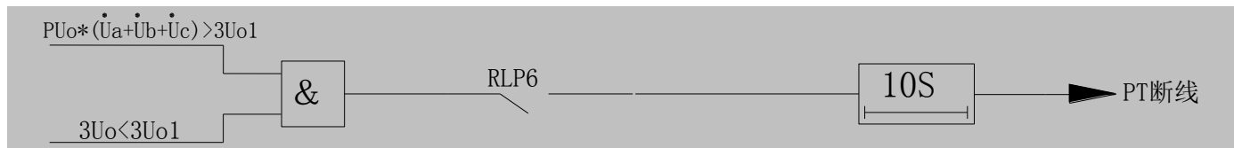
图 4 PT 断线报警逻辑框图
