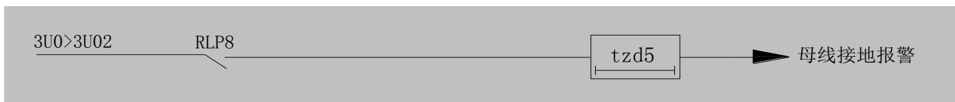
图 3 接地保护逻辑框图
