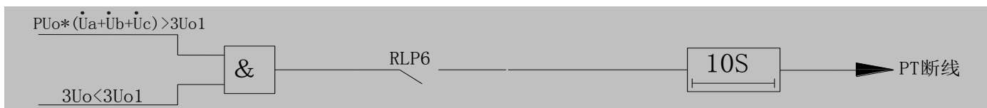
图 4 PT 断线报警逻辑框图
