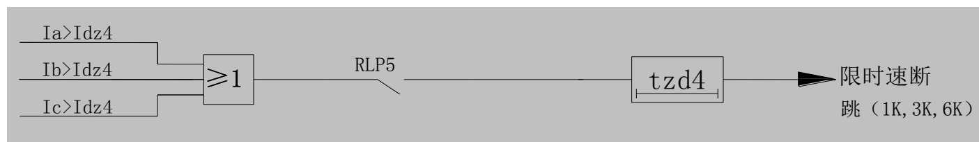
图 6 限时速断逻辑框图
