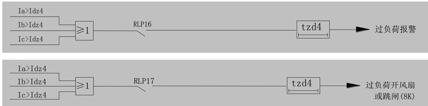
图 5 过负荷保护逻辑框图
