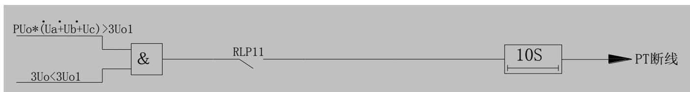
图 7 PT 断线报警逻辑框图
