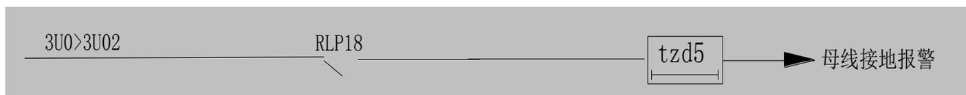
图 6 接地保护逻辑框图
