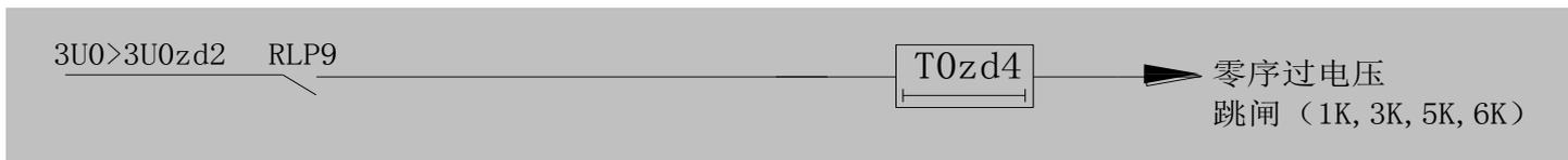
图 4 零序过电压逻辑框图
