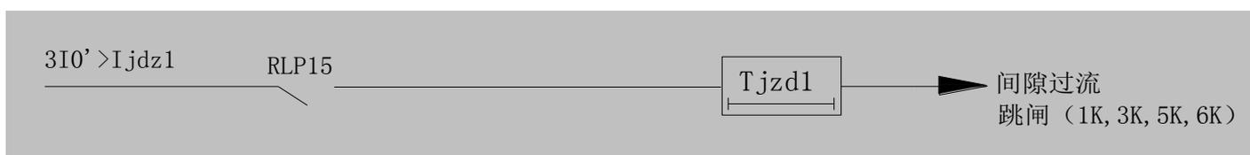
图 10 间隙零序逻辑框图
