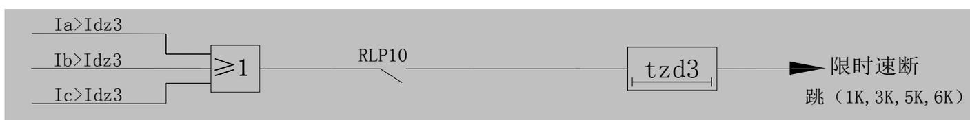
图 9 限时速断逻辑框图
