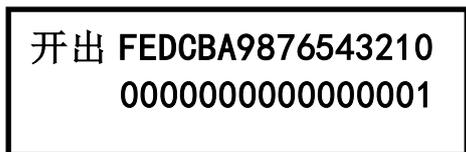
通过“→”、“←”键可选择“开出 1”或“开出 2”。按“↑”进入开出编辑状态。在编辑状态，通过“↑”、“↓”、“→”、“←”键可对开出量进行编辑。“1”对应输出继电器闭合或指示灯亮，“0”对应输出继电器断开或指示灯灭。编辑完成后按“确认”键，在核实输入正确的 PASSWORD2 后，再按“确认”键后，相应的
