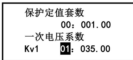
状态下，通过“↑”、“↓”、“→”、“←”键可对定值进行编辑。编辑完成后按“确认”键，在核实输入正确的 PASSWORD1 后，再按“确认”键后本号定值修改有效，按“取消”键无效。整定值定义及说明详见后面“定值清单”。
